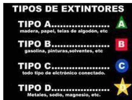
Imagen Nro.7.- Detalle tipos de extintores.
