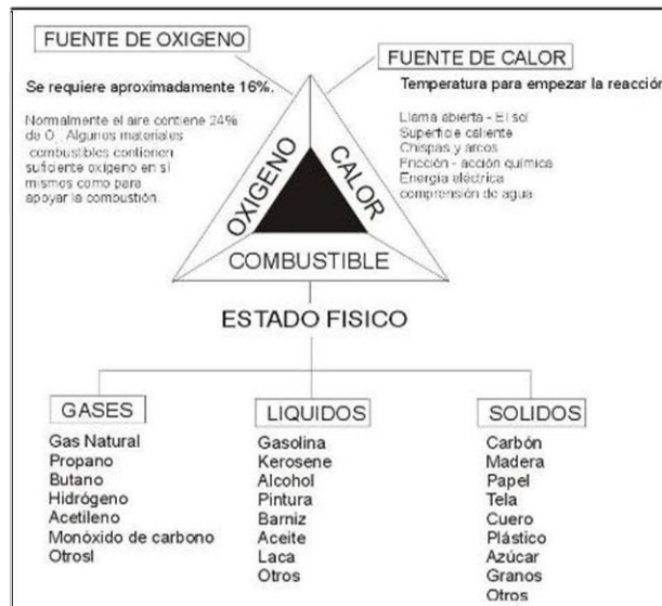
Imagen Nro. 1.- Detalle de los elementos del incendio.
