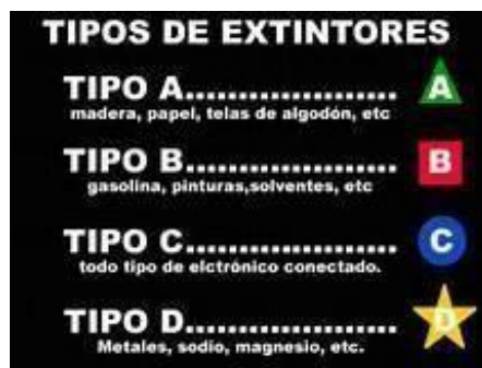
Imagen Nro.7.- Detalle tipos de extintores.
