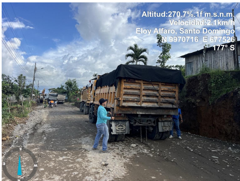
Registro Fotográfico 4. Volquetas con lona para el transporte de materiales
